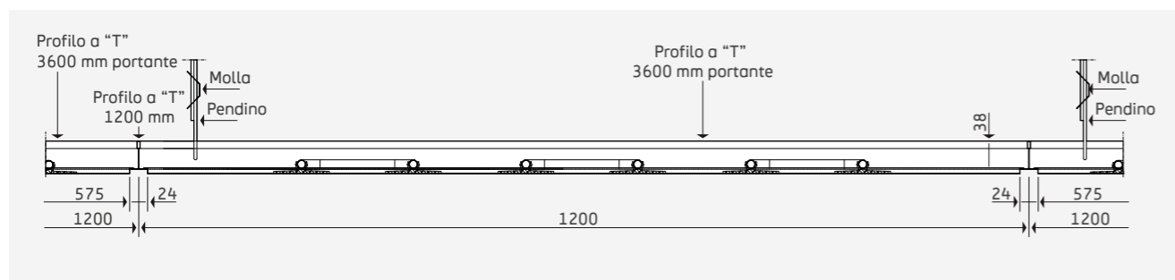
Sezione struttura a "T" base 24 mm del sistema GK60X120 PSV
